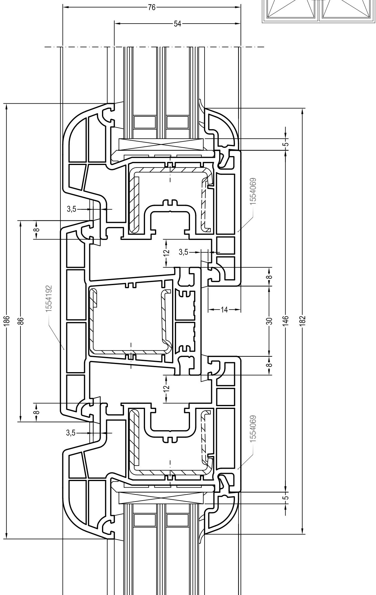
Чертежи узлов импостных окон и балконных дверей
