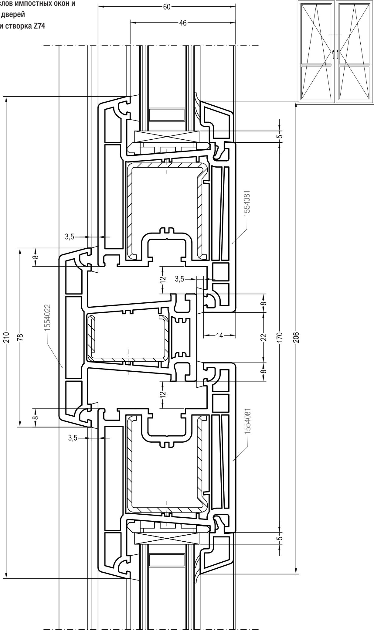
Чертежи узлов импостных окон и балконных дверей
