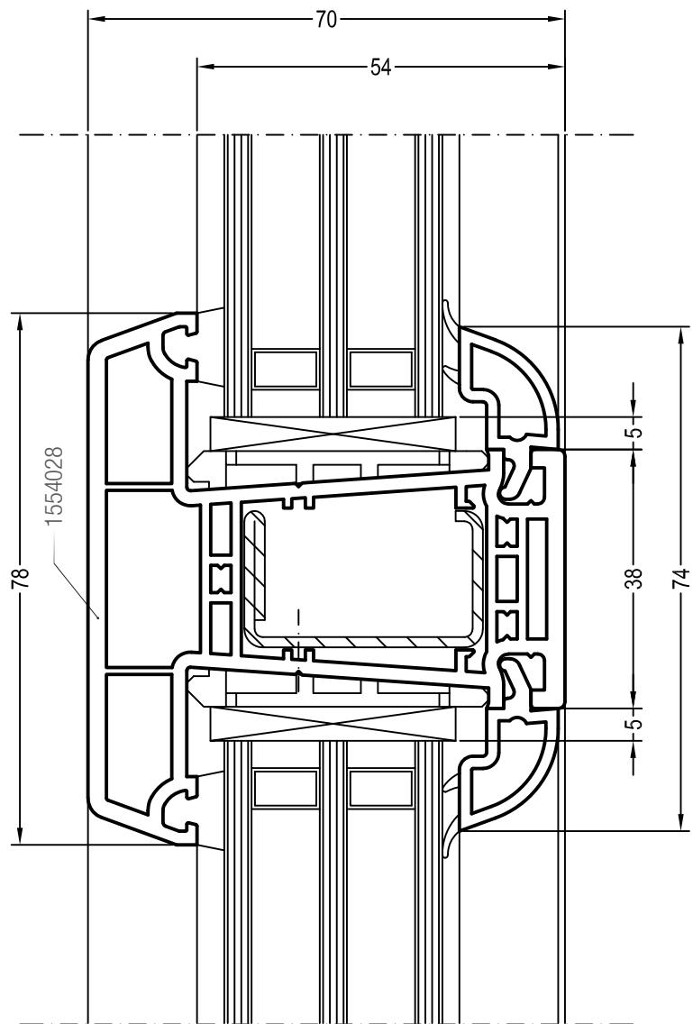
Чертежи узлов наклонно-сдвижных дверей (PSK-порталов)
