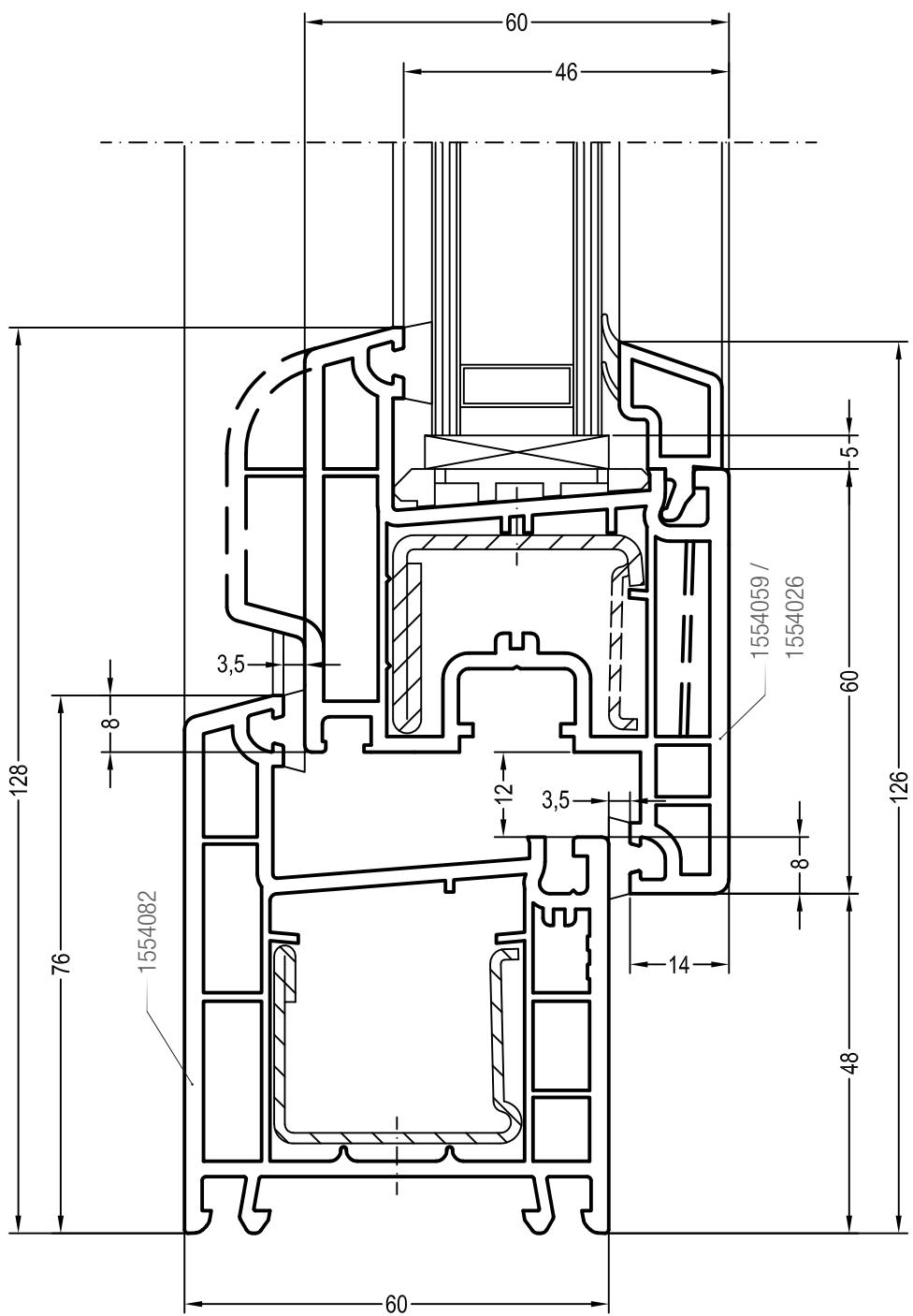
Чертежи узлов окон и балконных дверей
