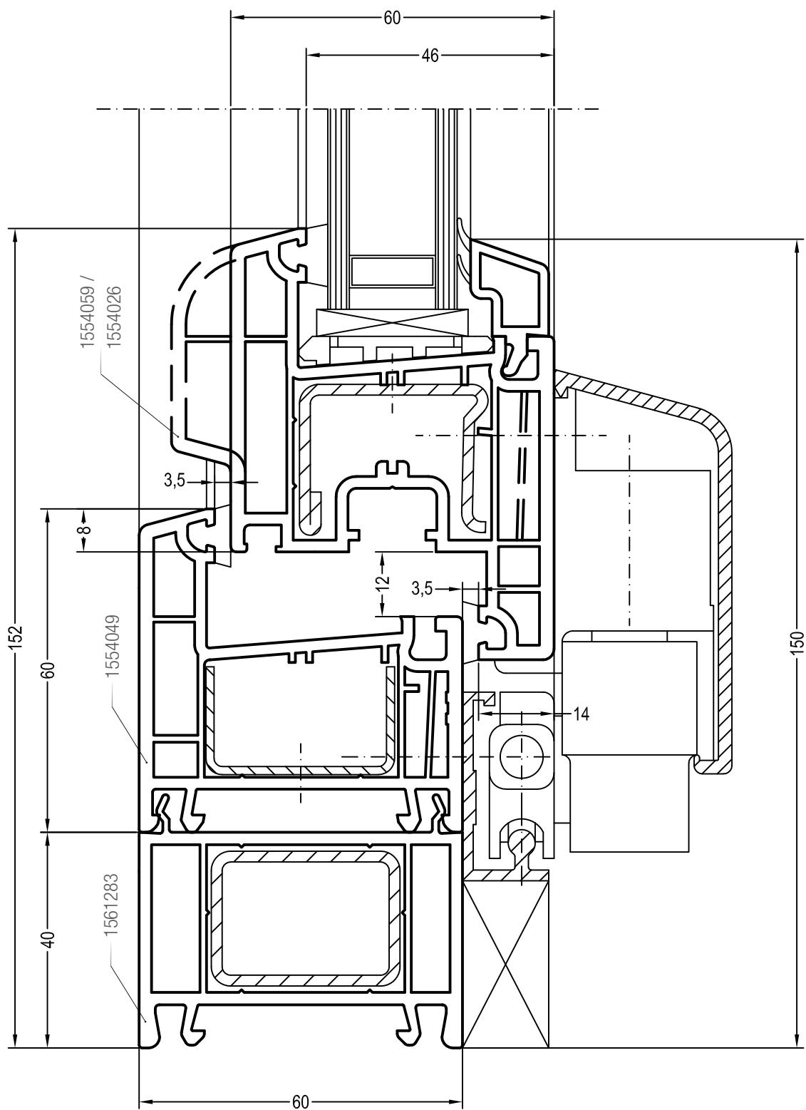
Чертежи узлов наклонно-сдвижных дверей (PSK-порталов)
