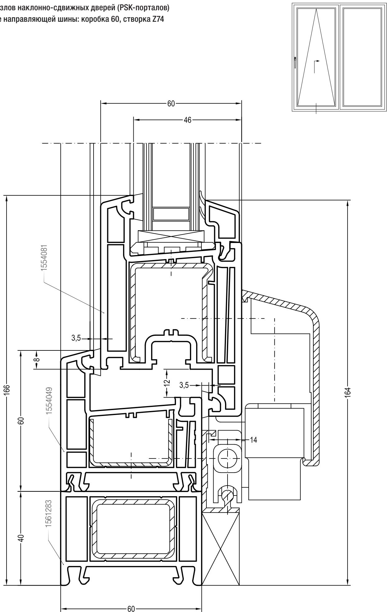
Чертежи узлов наклонно-сдвижных дверей (PSK-порталов)
