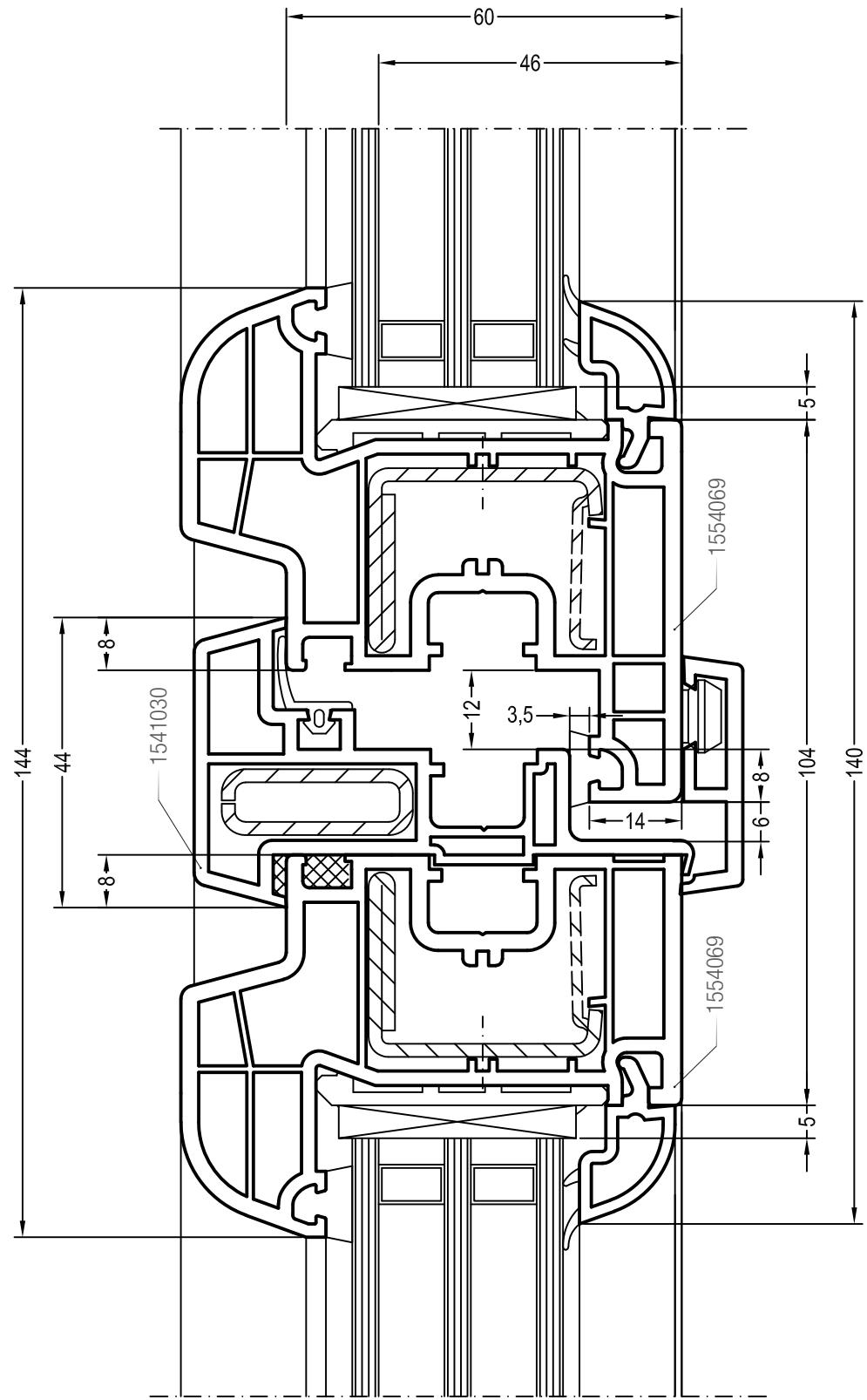
Чертежи узлов безимпостных окон и балконных дверей
