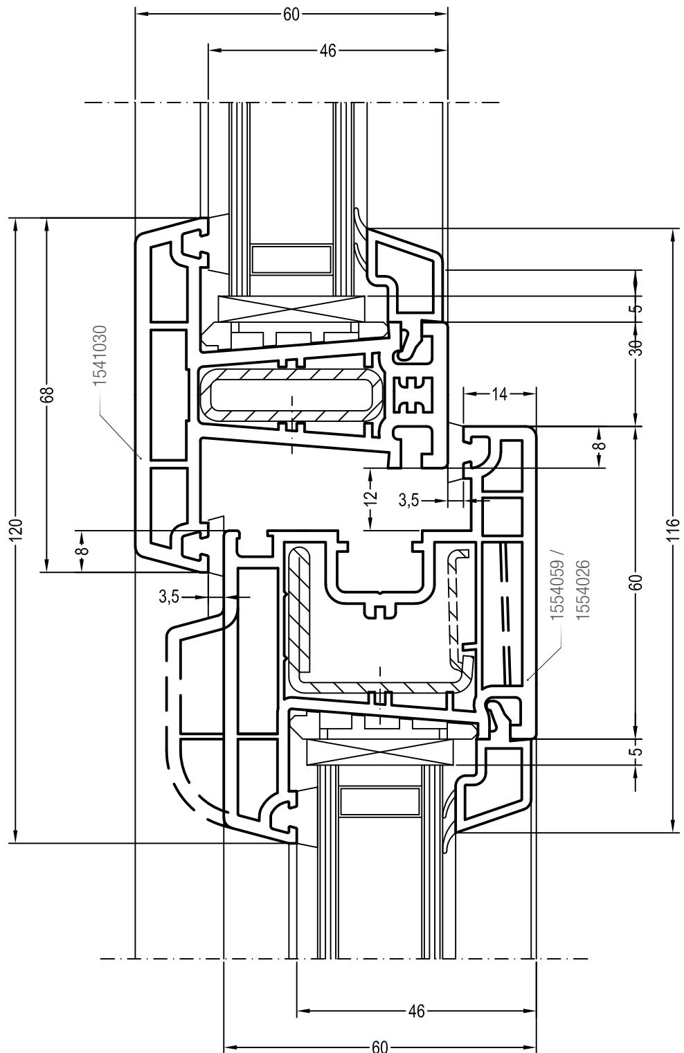
Чертежи узлов окон и балконных дверей с глухой частью
