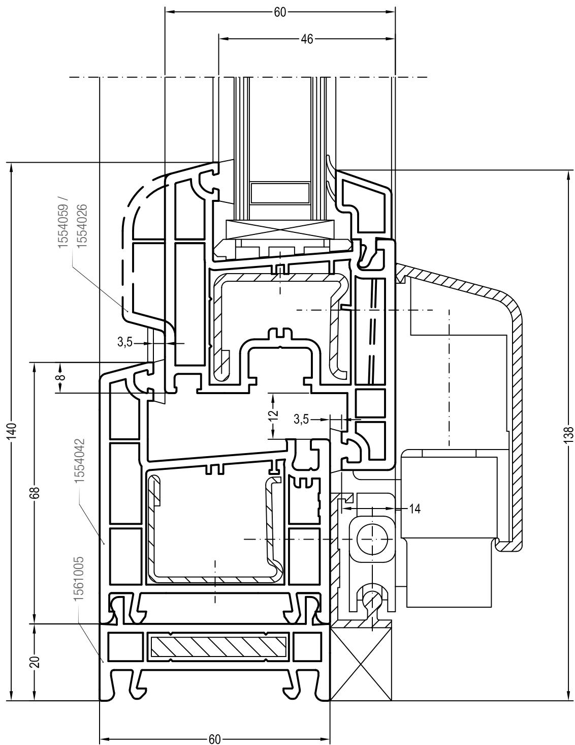
Чертежи узлов наклонно-сдвижных дверей (PSK-порталов)
