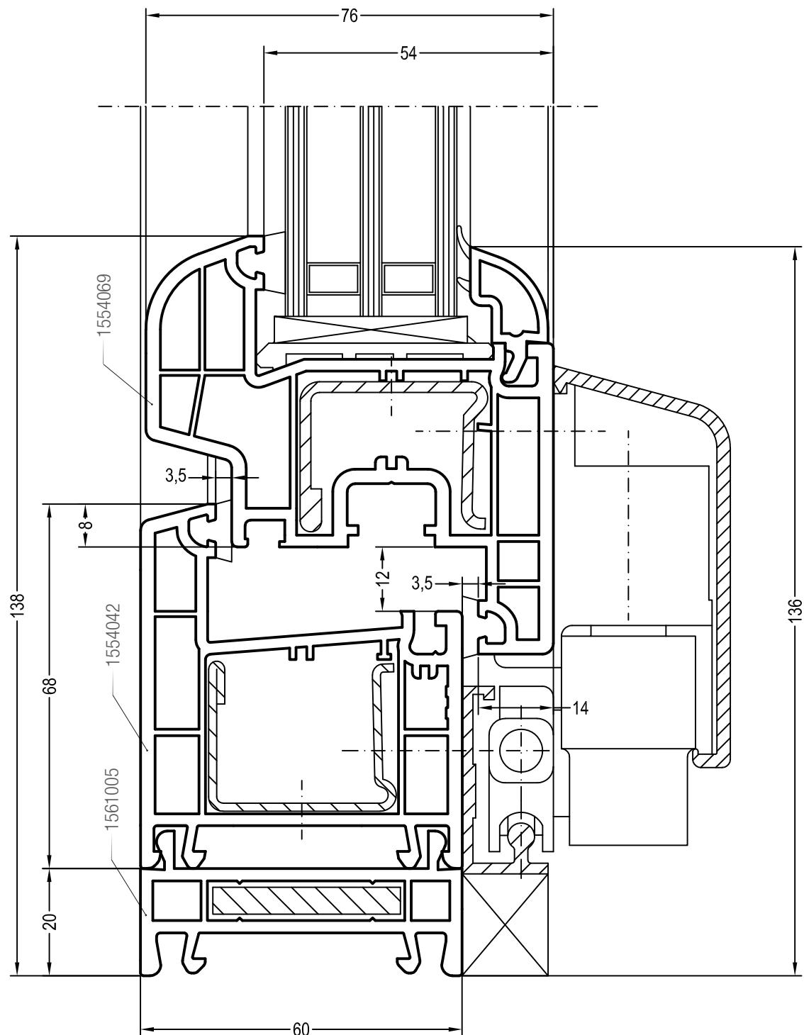
Чертежи узлов наклонно-сдвижных дверей (PSK-порталов)
