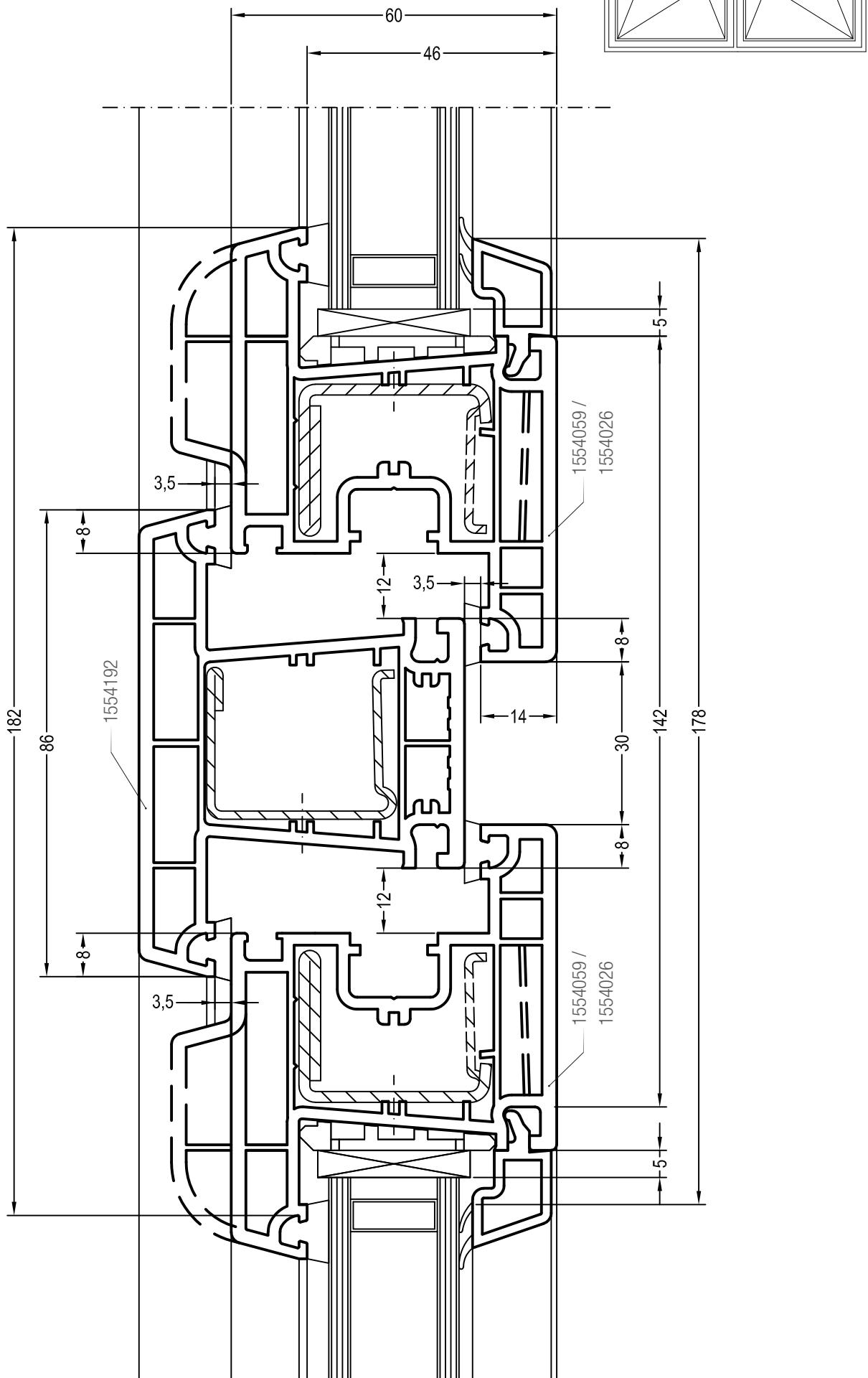
Чертежи узлов импостных окон и балконных дверей
