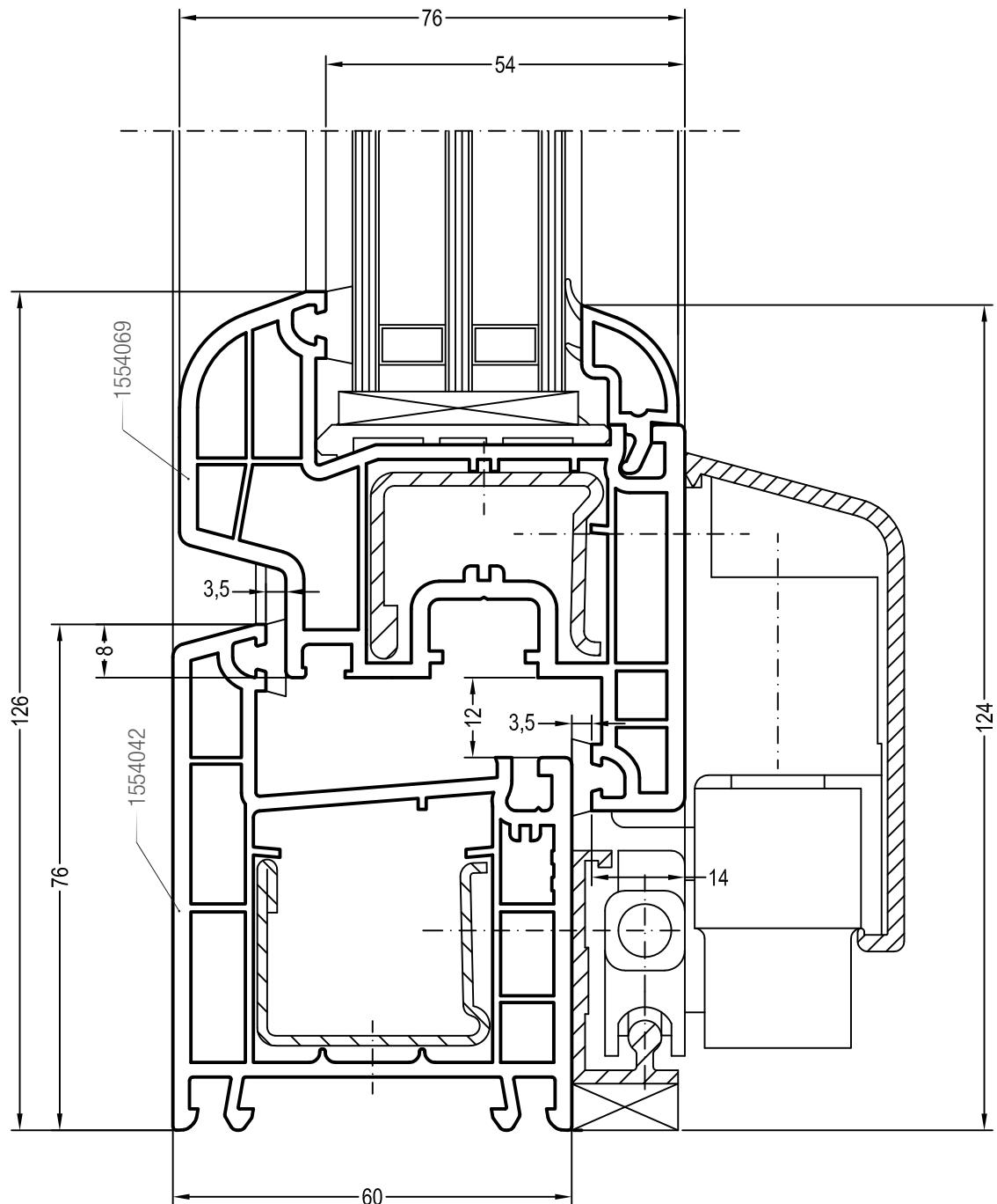
Чертежи узлов наклонно-сдвижных дверей (PSK-порталов)
