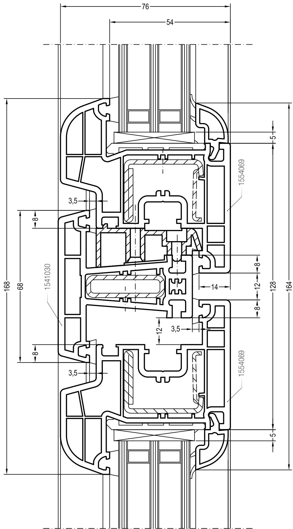
Чертежи узлов безимпостных окон и балконных дверей
