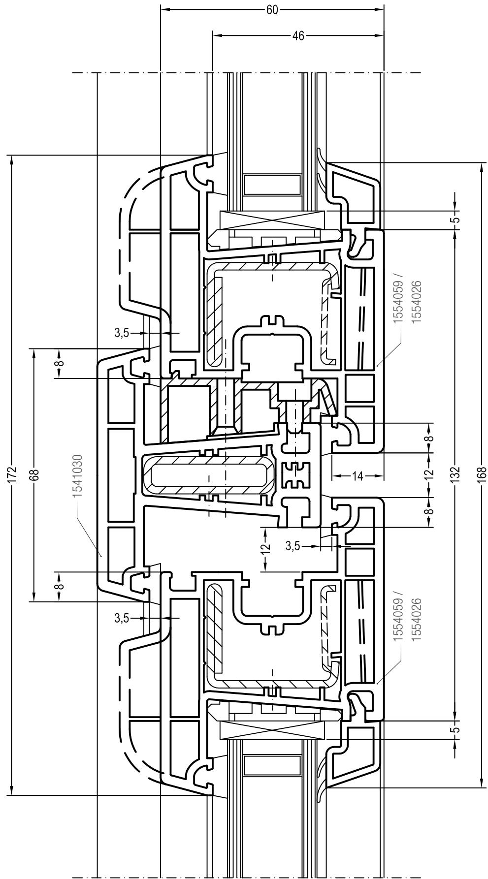
Чертежи узлов безимпостных окон и балконных дверей
