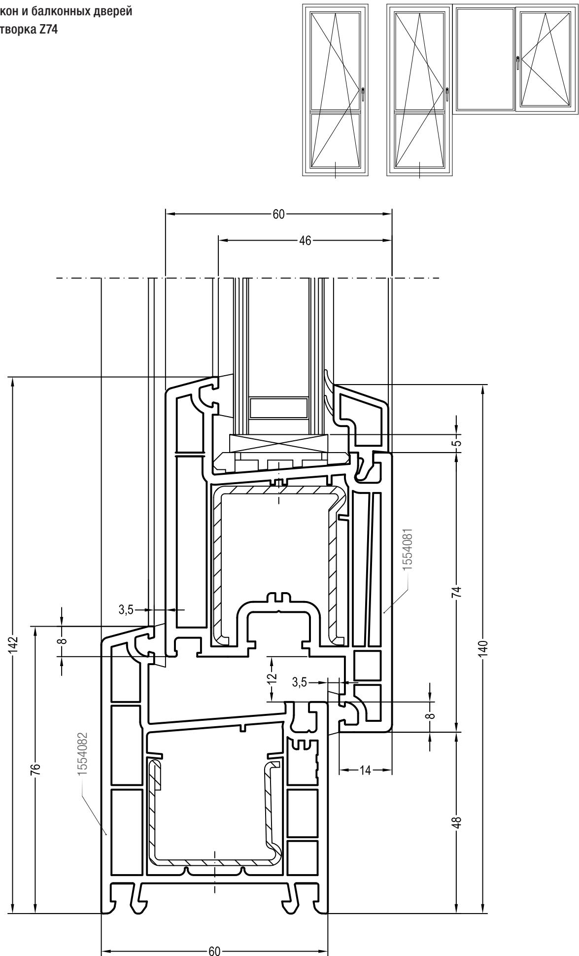
Чертежи узлов импостных окон и балконных дверей
