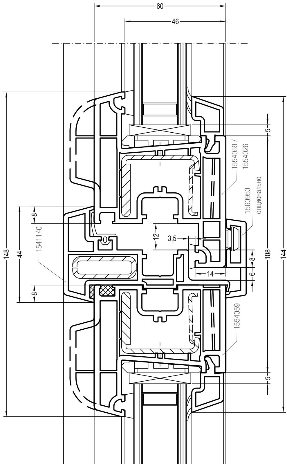
Чертежи узлов безимпостных окон и балконных дверей
