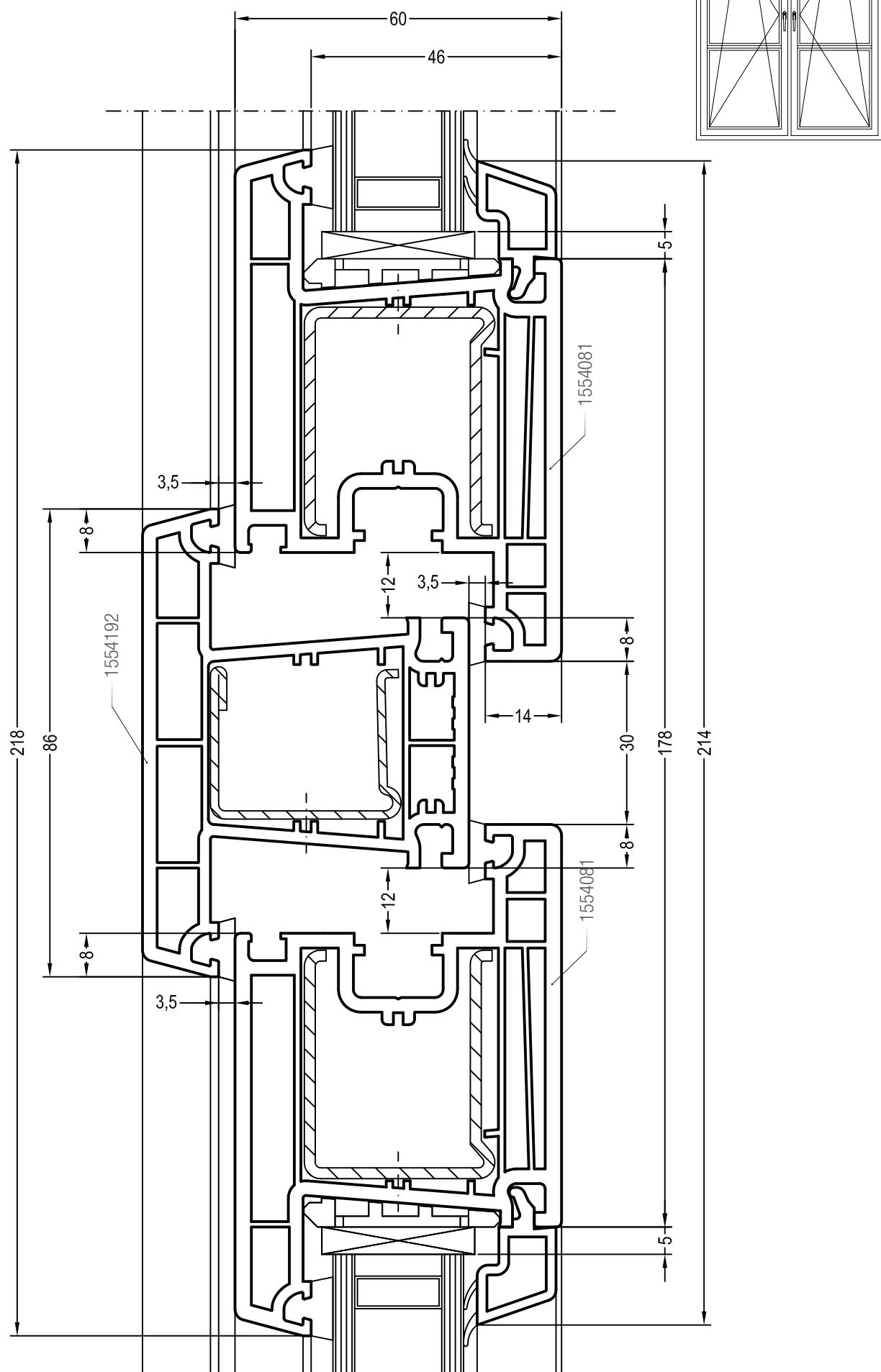
Чертежи узлов безимпостных окон и балконных дверей
