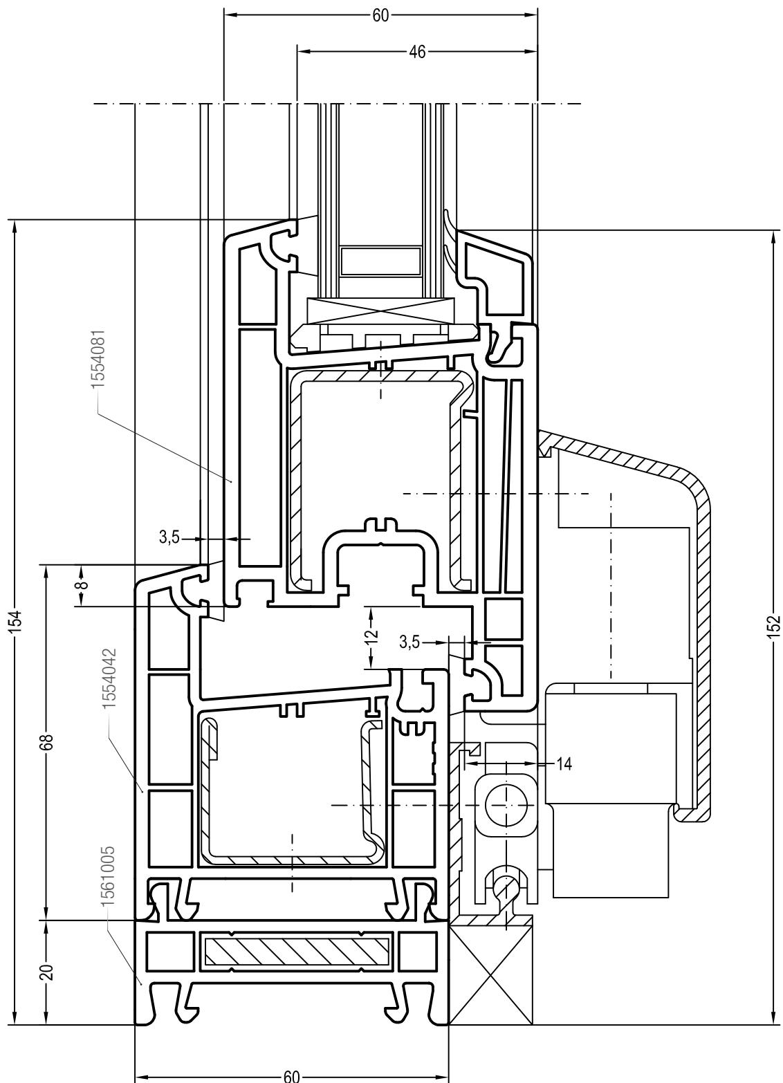
Чертежи узлов наклонно-сдвижных дверей (PSK-порталов)
