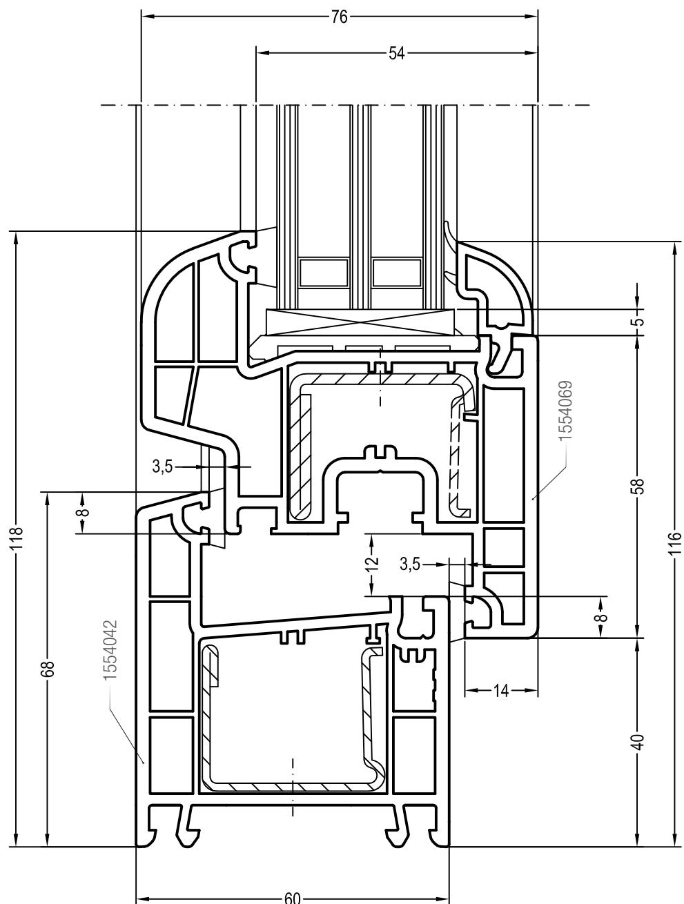
Чертежи узлов окон и балконных дверей
