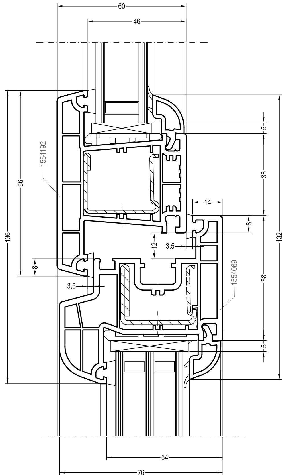
Чертежи узлов окон и балконных дверей с глухой частью
