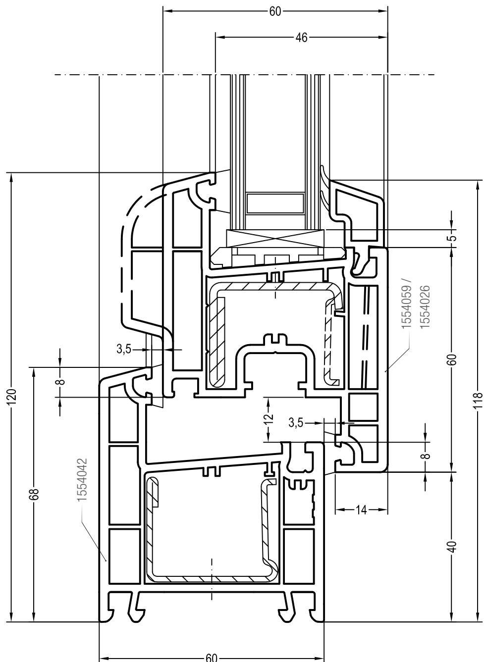
Чертежи узлов окон и балконных дверей
