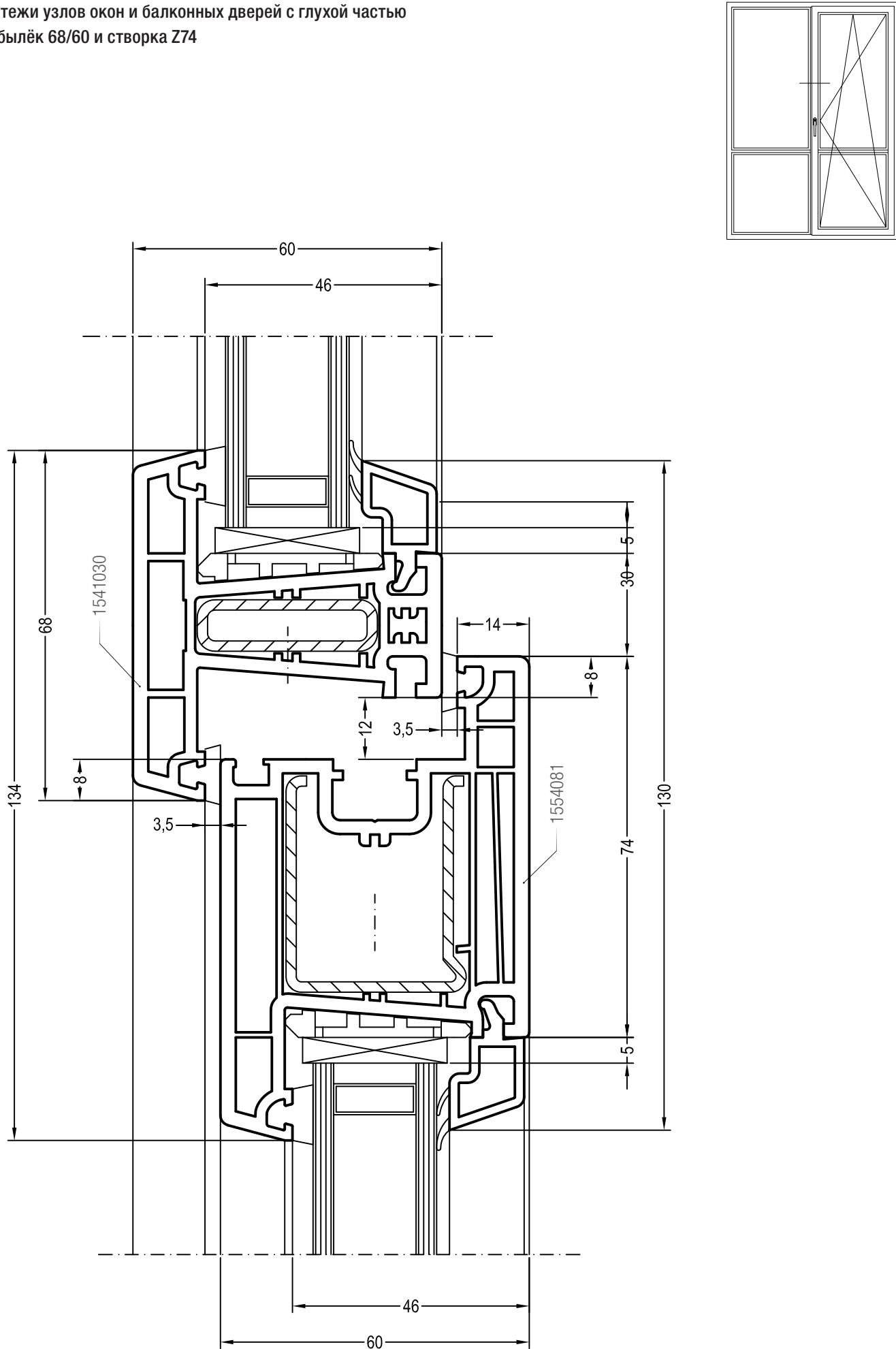
Чертежи узлов окон и балконных дверей с глухой частью
