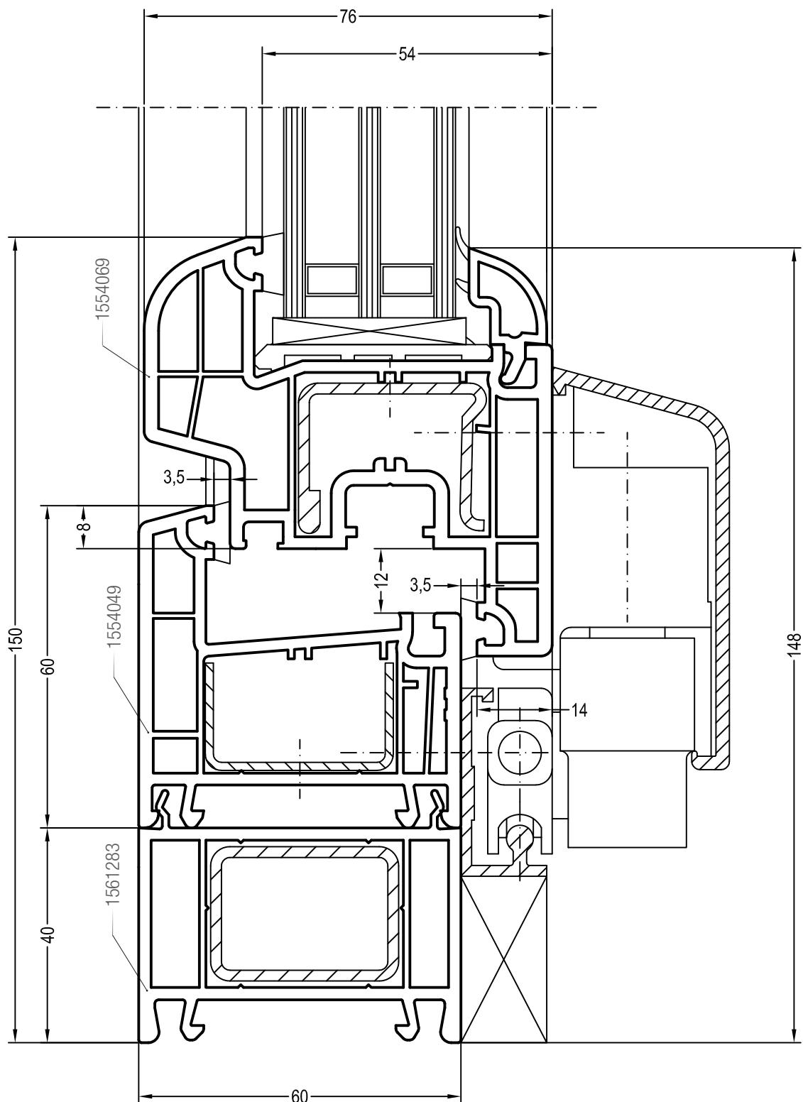
Чертежи узлов наклонно-сдвижных дверей (PSK-порталов)
