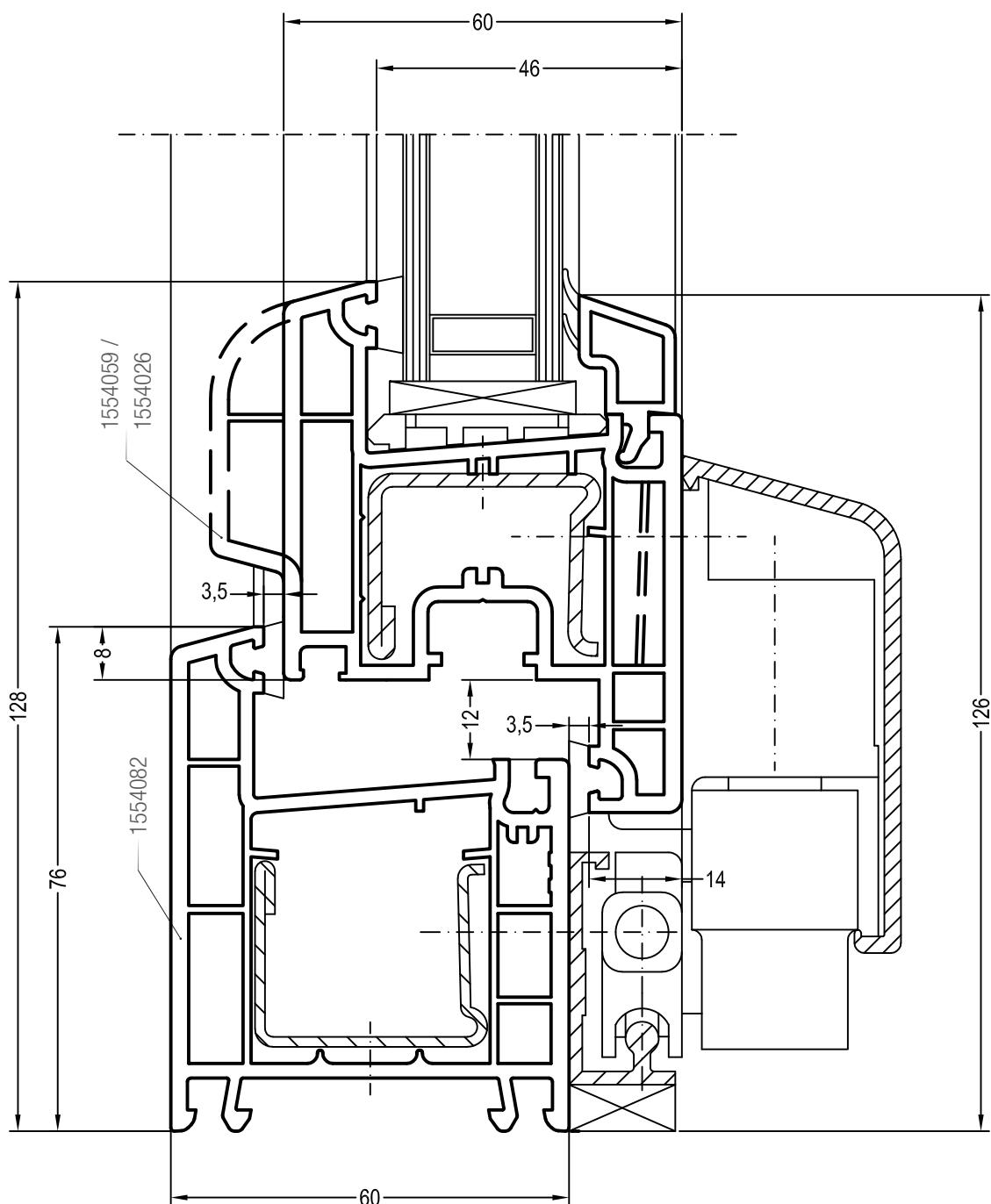
Чертежи узлов наклонно-сдвижных дверей (PSK-порталов)
