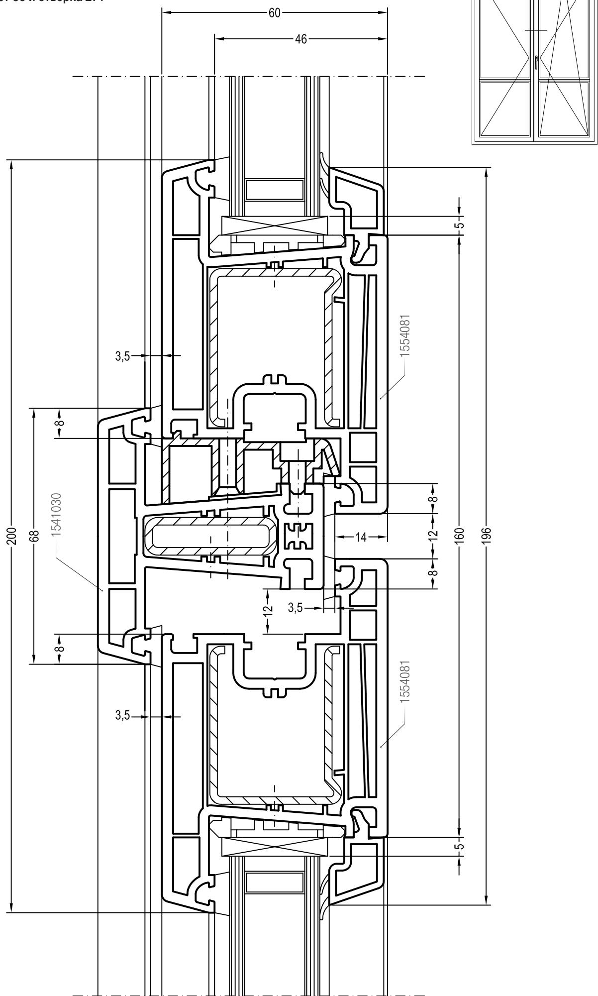
Чертежи узлов безимпостных окон и балконных дверей
