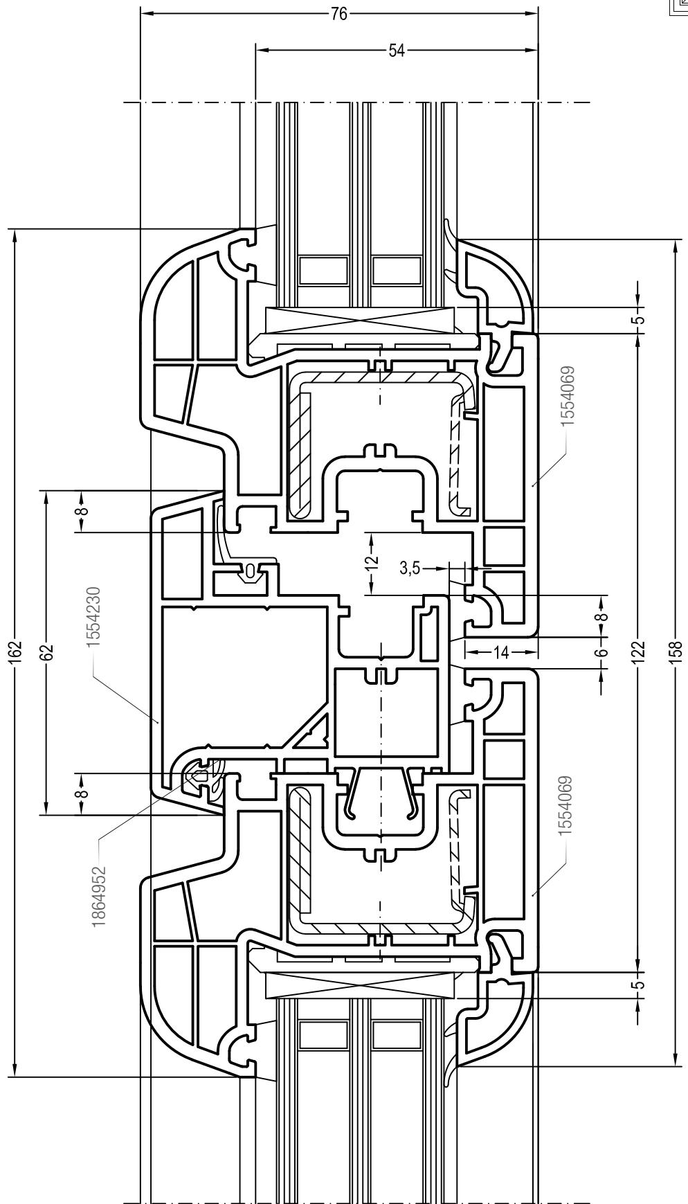
Чертежи узлов безимпостных окон и балконных дверей
